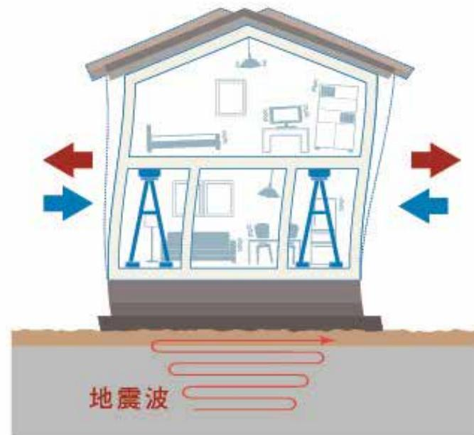
建築基準法にも定められている、近年の新築住宅なら標準的に保持している性能です。建物の強度を上げる地震対策ですが、建物が地震エネルギーを全て受け止めて耐えようとするため、構造躯体へのダメージが大きく、余震や別の地震の際に本来の性能を発揮できない可能性があります。
