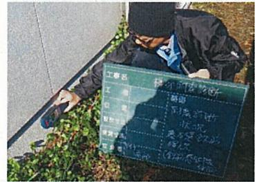
実際に調査をしている様子です。壁の材質・筋かいの有無・屋根の重さ・劣化状況(基礎のヒビ割れ・外壁の割れ・雨染み)などを調査し、調査結果を耐震診断ソフトに入力し耐震診断書を作成します。その耐震診断書をもとに、住宅の耐震性をご報告します。
